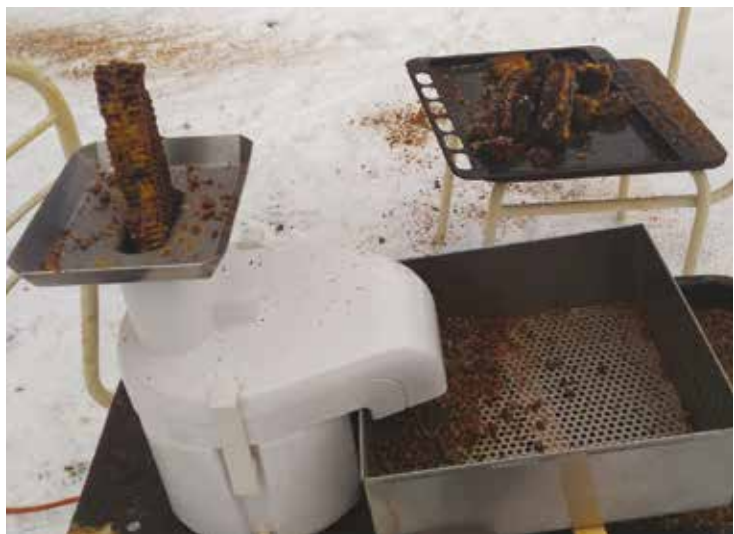
Obr. 1: Mlýnek na zpracování pergy a nerezové síto na separaci peletky pergy od vosku. Foto M. Staroň, 2018
