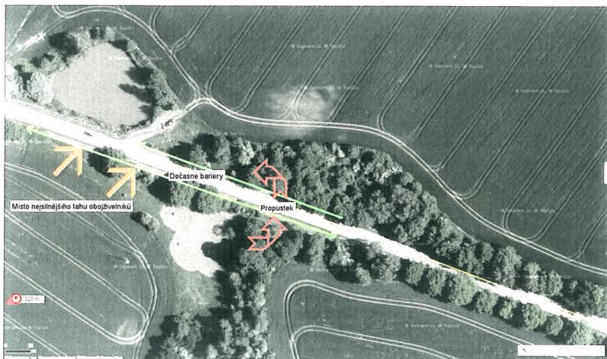
Obr. 4: Zákres kolizního úseku s vyznačenými dočasnými bariérami a možností využití propustku pro instalaci trvalých bariér
